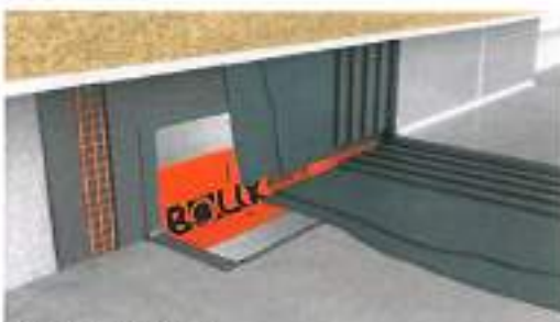
Połączenie ściany z posadzką
