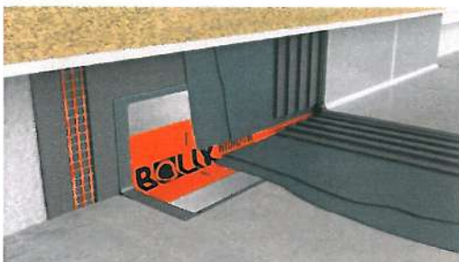
Połączenie ściany z posadzką
